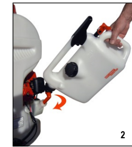
Beim Befüllen (Bild 1) den Kanister möglichst gerade halten. Um den Tankstutzen vollständig zu entleeren, Kanister leicht kippen (Bild 2), damit das Restbenzin aus dem Tankstutzen abfließen kann.
