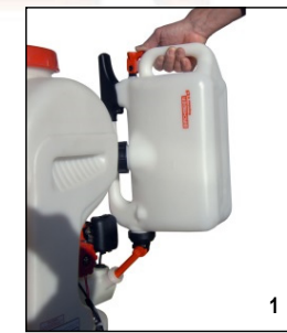
Beim Befüllen (Bild 1) den Kanister möglichst gerade halten. Um den Tankstutzen vollständig zu entleeren, Kanister leicht kippen (Bild 2), damit das Restbenzin aus dem Tankstutzen abfließen kann.
